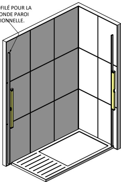
POSITIONNER LES PROFILÉS MURAUX SUR LE PLATEAU DANS UNE POSITION APPROPRIÉE. S'ASSURER À L'AIDE D'UN NIVEAU À BULLE, PUIS MARQUEZ LES TROUS DE FIXATION AVEC UN CRAYON.
