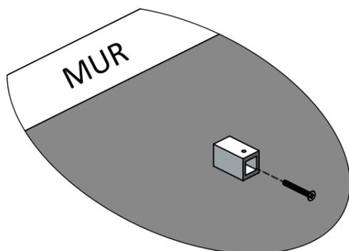
UNE FOIS ASSEMBLÉ, MARQUEZ ET PERCEZ L'EMBASE MURALE DE LA BARRE SUPÉRIEURE (PIÈCE 5). S'ASSURER QUE L'EMBASE MURALE DE LA BARRE SUPÉRIEURE EST DE NIVEAU ET QUE LA VIS SANS TÊTE EST ORIENTÉE VERS LE HAUT AVANT DE LA FIXER AU MUR À L'AIDE DES PIÈCES 10 & 12. MONTER L'ASSEMBLAGE DE LA BARRE.
