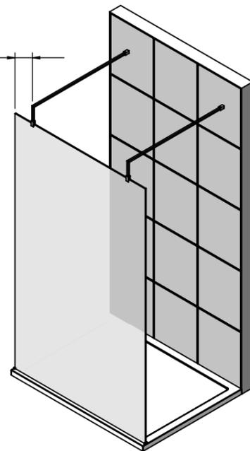
POSITIONNER LES PIEDS DE SUPPORT DE LA PAROI DE PART ET D'AUTRE DU PANNEAU DE VERRE ET LES METTRE EN PLACE.
