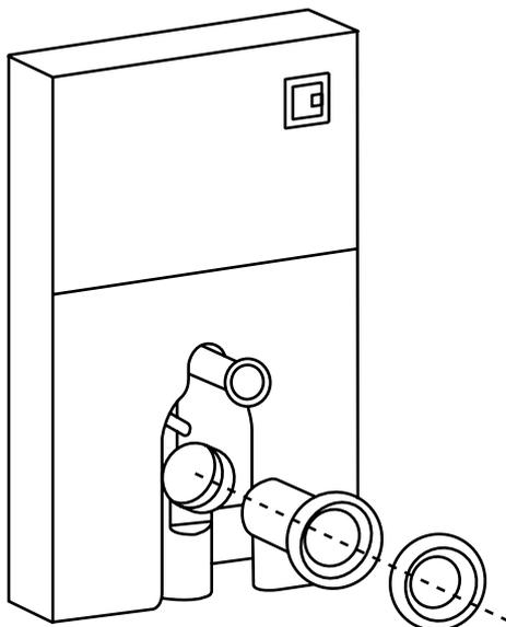
Installer le tuyau d'évacuation et le manchon de raccordement.
