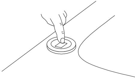
8. Il est possible de régler la puissance des buses en tournant l'anneau extérieur du bouton de commande marche/arrêt lorsque le système est en marche.
