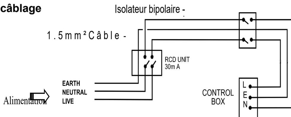
Double Pole Isolator – Isolateur bipolaire
