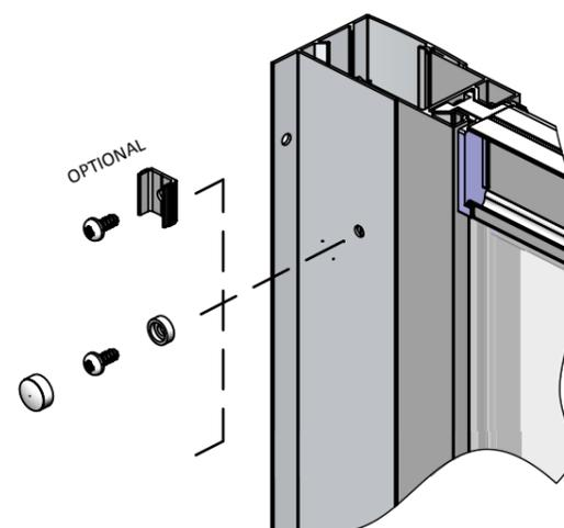
LORSQUE L'ENCEINTE EST PRÊTE À ÊTRE FIXÉE, PERCER LES TROUS DANS LE PROFILÉ MURAL ET LE POTEAU D'ANGLE AVEC UNE PERCEUSE DE 3 MM. DANS LE PROFIL MURAL ET LE PION D'ANGLE AVEC UNE PERCEUSE DE 3 mm. (ASSUREZ-VOUS DE NE PERCER QU'UNE SEULE ÉPAISSEUR DE MUR) PUIS FIXEZ LE CADRE AVEC LES ÉLÉMENTS 10, 11\* & 12\*.
