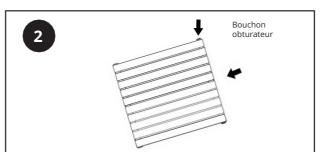
Toujours sur une surface étanche, mettez le radiateur en position inclinée et retirez le bouchon obturateur supérieur. Vous pourrez ainsi insérer l'élément dans le radiateur sans perte de glycol et vous pourrez vérifier que le niveau de glycol est correct. \*Veuillez voir l'étape 1 des "Problèmes de température" pour connaître les niveaux de glycol corrects.
