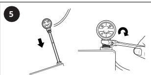
Insérez lentement l'élément dans l'entrée, en gardant le radiateur en position inclinée pour éviter tout débordement. À l'aide d'une clé réglable, tournez dans le sens des aiguilles d'une montre pour serrer l'élément dans l'entrée du radiateur. NE PAS tourner la tête manuellement car cela risque d'endommager l'élément de manière irrémédiable.
