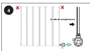
Si la sonde de la température est positionnée sur le côté gauche lorsque l'élément est orienté vers l'avant, l'élément devrait être installé sur l'entrée droite pour permettre à la sonde d'être positionnée en bas comme indiqué à l'étape 2. \*Ce sera l'inverse si la sonde de la température est positionnée sur le côté droit de l'élément (orienté vers l'avant).
