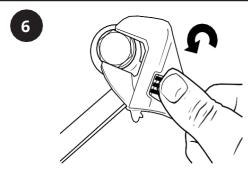
À l'aide d'une clé réglable, vérifiez tous les bouchons obturateurs d'entrée/sortie pour assurer qu'ils sont bien fixés afin d'éviter toute fuite de glycol avant la mise en marche du radiateur. Veillez à ne pas trop serrer les bouchons d'obturateurs.
