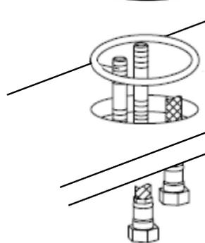
\*N'oubliez pas d'installer le joint torique ou la rondelle entre le corps du mitigeur et l'appareil sanitaire\*
