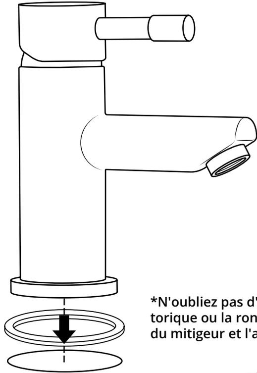
\*N'oubliez pas d'installer le joint torique ou la rondelle entre le corps du mitigeur et l'appareil sanitaire\*
