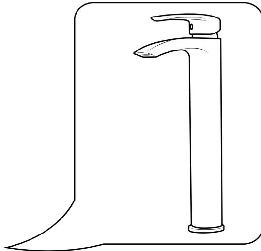
\*N'oubliez pas d'installer le joint torique ou la rondelle entre le corps du mitigeur et l'appareil sanitaire\*
