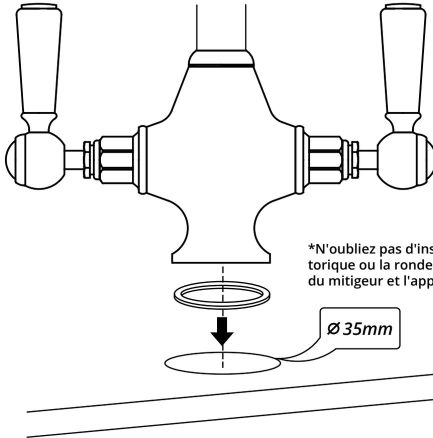
\*N'oubliez pas d'installer le joint torique ou la rondelle entre le corps du mitigeur et l'appareil sanitaire\*
