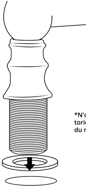
\*N'oubliez pas d'installer le joint torique ou la rondelle entre le corps du mitigeur et l'appareil sanitaire\*
