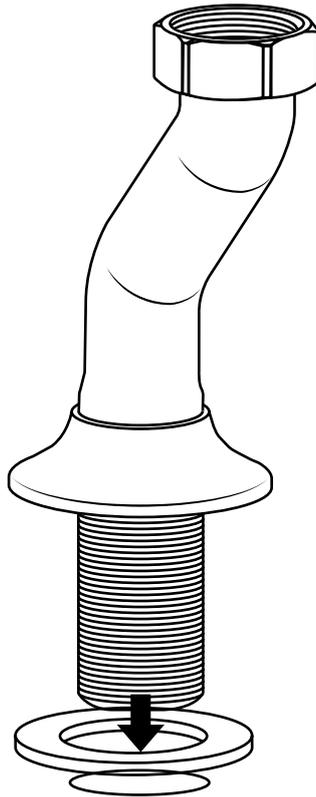
\*N'oubliez pas d'installer le joint torique ou la rondelle entre le corps du mitigeur et l'appareil sanitaire\*
