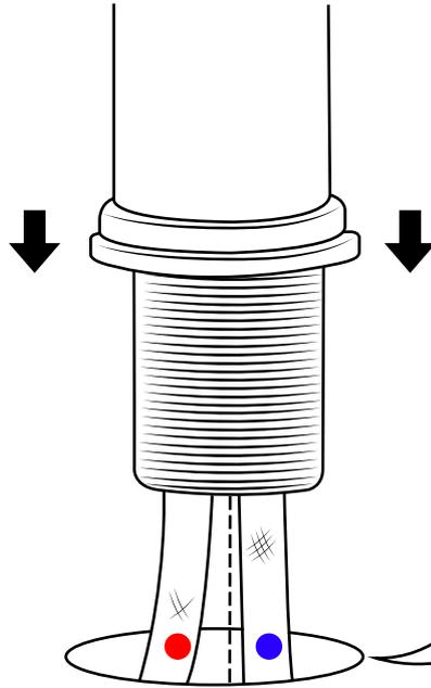
\*N'oubliez pas d'installer le joint torique ou la rondelle entre le corps du mitigeur et l'appareil sanitaire\*
