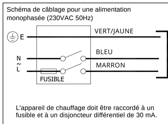
Pour les appareils de chauffage équipés d'une fiche britannique ou européenne, utilisez une prise en bon état et adaptée à l'appareil.
